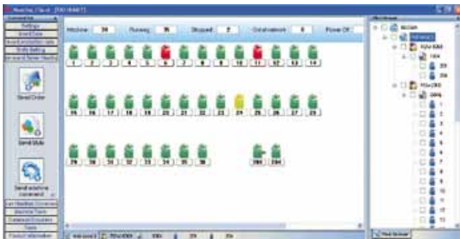
Controllo remoto della macchina e stato della sala macchina. Machine remote control and machines room condition monitoring.
